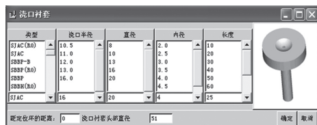
图 6 手机充电器底盖主流道衬套尺寸选择
